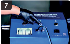
Démarrer la réparation
