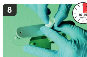
Visser le piston de 1 à 2 tours pour générer une pression positive tout en maintenant l'injecteur
