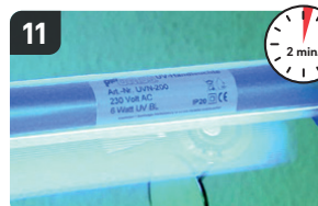
Installer la lampe UV au-dessus de la zone impactée pour faire durcir la résine
