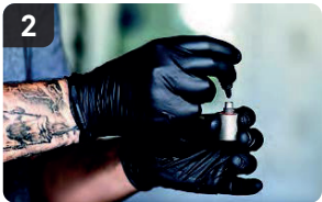
Remplir le réservoir de chambre de résine avec la résine de réparation
