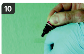
Mettre une goutte de résine de finition sur une feuille de Mylar puis la déposer sur l'impact
