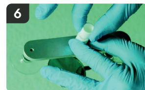
Pour générer une pression négative, dévisser le piston de 1/2 à 1 tour tout en tenant l'injecteur
