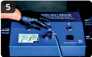
Démarrer le processus d'étanchéification de la zone endommagée
