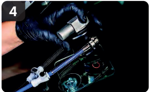
Positionner l'injecteur sur le point d'impact
