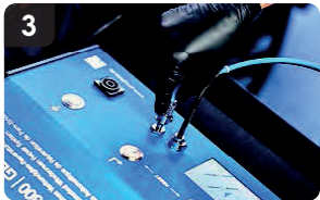
Connecter les tuyaux de raccordement (sur l'appareil et l'injecteur)
