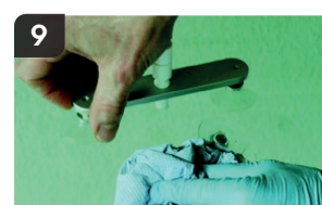
Retirer la base de réparation puis nettoyer l'excès de résine à l'aide d'un chiffon en papier
