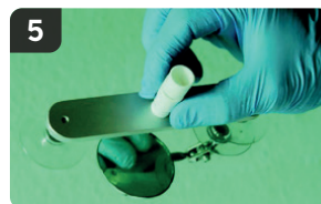
Visser l'injecteur jusqu'à ajustement complet du joint en caoutchouc à la vitre
